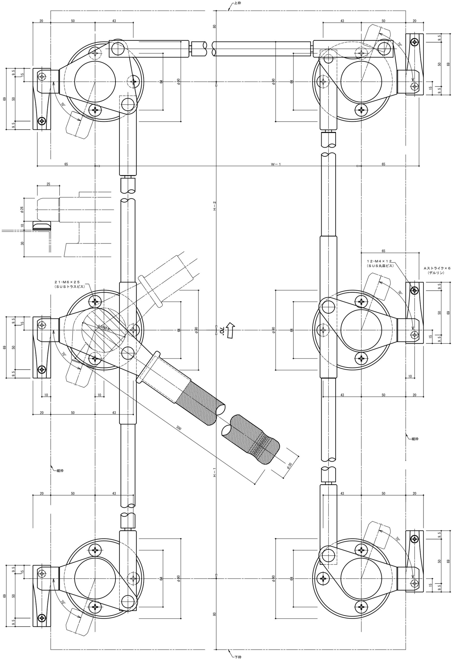
壁厚・左右勝手及びロット棒寸法 H-1・H-2・W-1 (最小寸法400) ご指示下さい。図は左勝手(LH)を示す。
